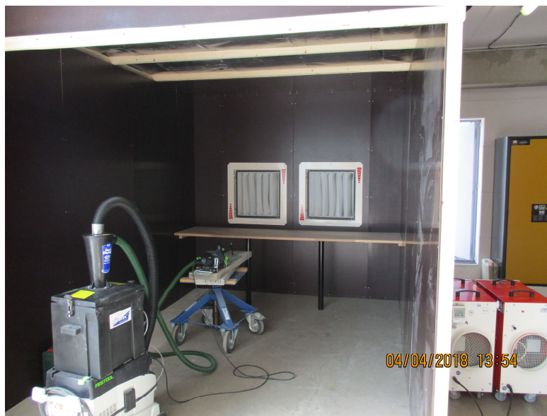
Bild 3: Kabine mit Rückluftführung außerhalb der Kabine, Luftzuführung über offene Frontöffnung
