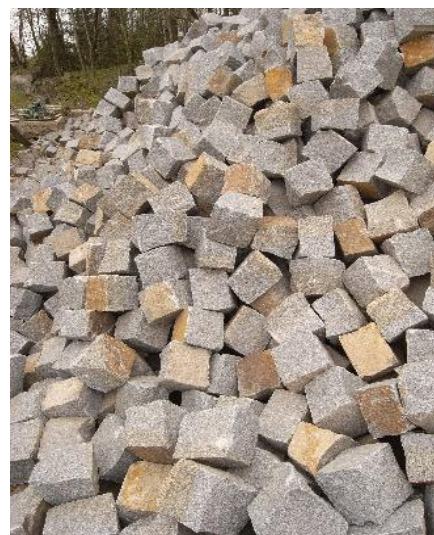
Pflaster aus Granit Hlinsko, Foto: F. Heinz
